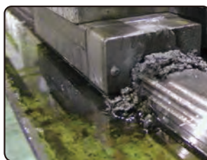
行走 3000km 時の試験品 3000km 走行時での試験品 Specimen after travelling 3,000 km
